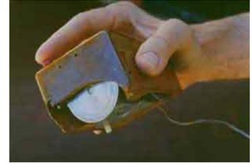
Figura 68 - O *mouse* de Engelbart só seria comercialmente um sucesso após o estabelecimento de interfaces visuais gráficas, duas décadas após sua invenção. O primeiro modelo era de madeira e só podia admitir um único botão (BOOTSTRAP. 2003).
